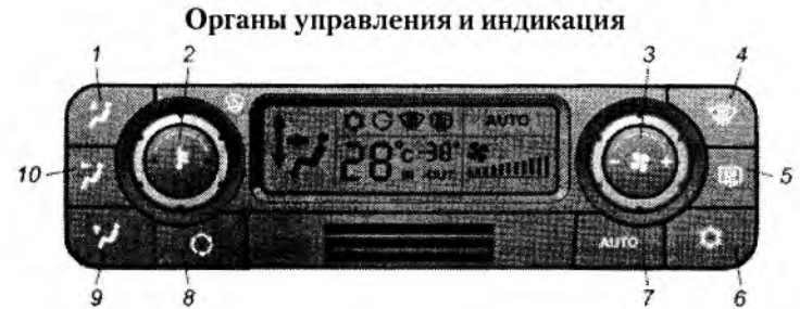
Рис. 6.26. Пульта управления отопительно-вентиляционной (климатической) установкой
